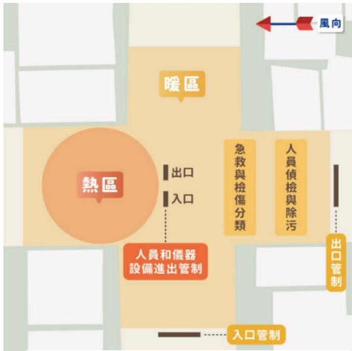
図8 放射線災害現場隔離管理指示図
